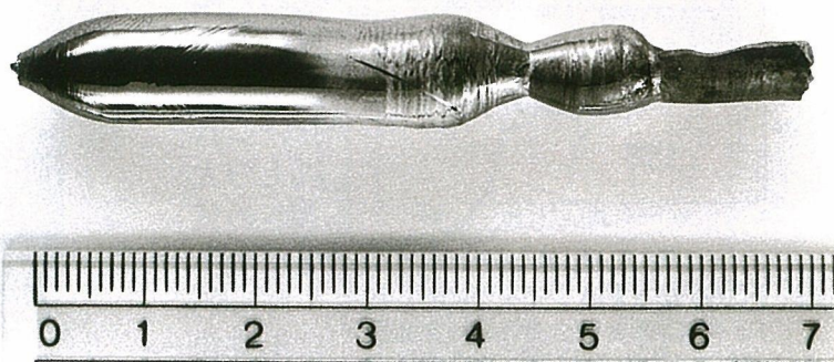
写真 100方向へ成長させた99% ^{10}\text{B} 単結晶
