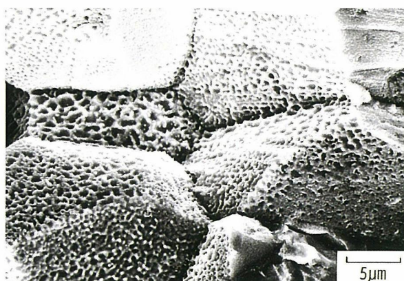
図2 ヘリウムを注入したステンレス鋼のクリープ破断試験片で観察された粒界破面
