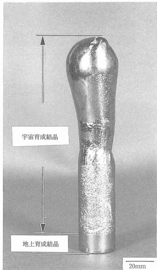
写真1. 1 微小重力下の浮遊帯域溶融法で作成したInSb単結晶
