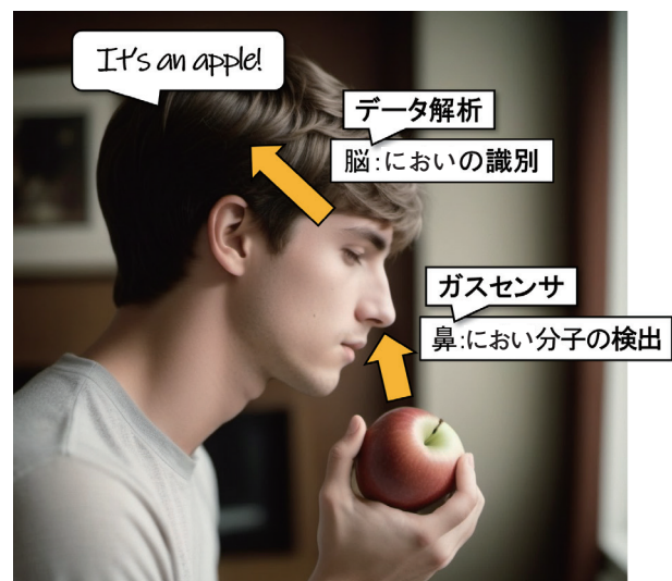
図-2 ヒトの嗅覚のメカニズムと、においセンサの対応。
