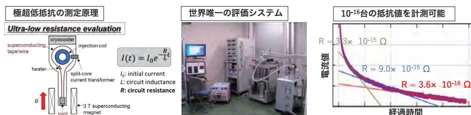
図2 超伝導接続の極めて低い電気抵抗を、温度、磁場（強さと向き）をパラメータとして計測できる世界唯一の内製評価システム
