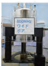
図2 通常はできないMoとNbの区別をNIMSの強磁場固体NMR装置を用いて行った
