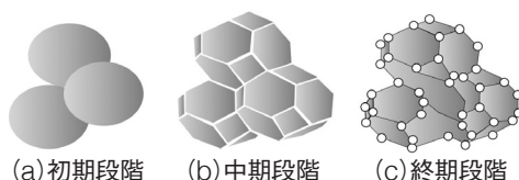
図1 Cobleによる焼結段階を区別するための単純幾何学モデル 1)
