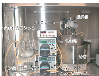
図 1 合成装置のセットアップ。左のフラスコの上が水酸化カルシウム懸濁液、下がコラーゲンを分散したリン撒水溶液。中央にチューブポンプ 2 台とそれを制御する pH コントローラ、右に恒温槽と攪拌機、合成容器が見える。
