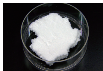
図 3 合成した HAp/Col 線維を凍結乾燥して得られる綿状の HAp/Col。
