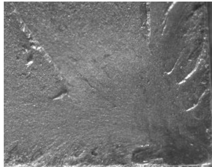
(c) 破壊起点近傍拡大
