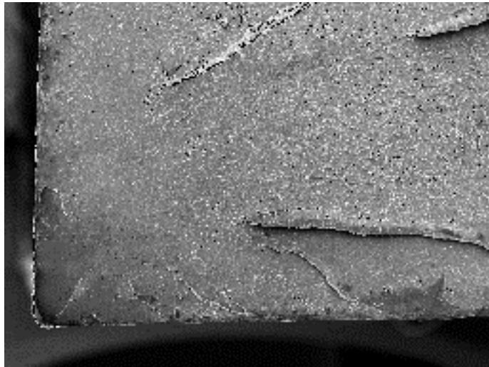
(a) 破壊起点近傍
