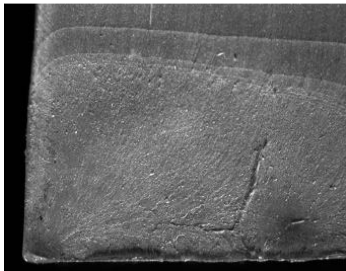
(b) 破壊起点近傍拡大
