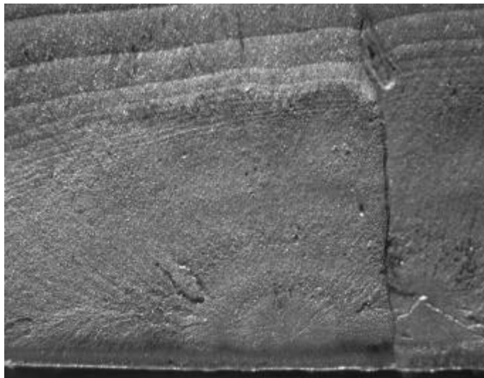
(b) 破壊起点近傍拡大
