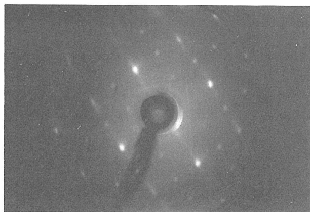
図4.14 WC(10 \bar{1} 0)清浄表面のLEEDパターン。 E_0=223.2\text{eV} 。
