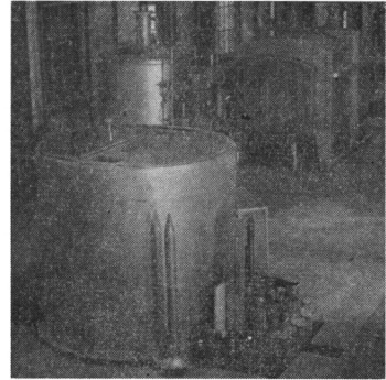
光輝ベル型焼鈍炉
