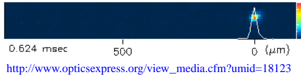
Fig. 7. ファイバヒューズが自然停止する直前の様子を捕らえたビデオ映像 (0.85 MB)。元の無彩色スケール映像を彩色スケール映像に変換してある。
