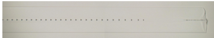
Fig. 5. 損傷を受けたファイバの光学顕微鏡写真。直径は 125 \mu\text{m} 。拡大率は Fig. 4 と同じである。
