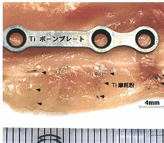
骨折部を固定したボーンプレートに付着した筋肉上のチタン摩耗粉
