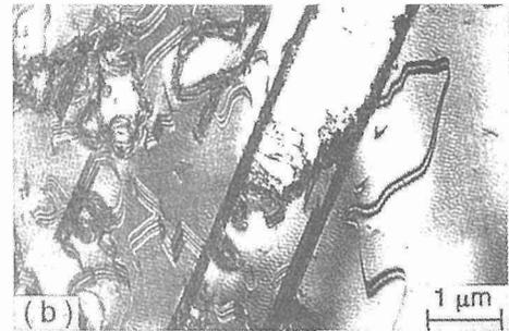
写真2-7 1683K/1.8ks保持後水中冷却したTi-48at.%AlのTEM組織(写真2-6(a)に対応)
