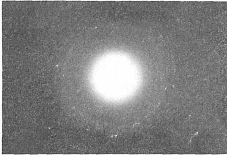
図8 電析物の電子線回折像
