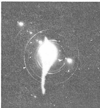
図6 図4における回折模様を試片電場による影響を知るため、図4の上に金ばくの標準模様が二重写し法によって重畳されている。
