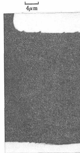
図2 電顕用シートメッシュの図1の単レンズによる像。直接倍率：250倍。光学的に10倍拡大。メッシュにおける小突起が観察されている。
