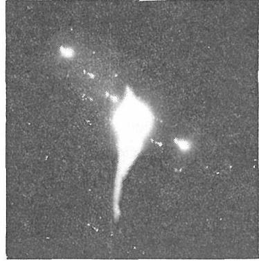
図4 ルビー試片の比較的厚い部分からの電子回折模様。試片の厚さ：約2,000Å。各回折斑点が分裂を示していることが注目される。図1の反射と比較せよ。分裂の方向は [110] に平行。電子線の波長：0.0305Å。陽画拡大なし。
