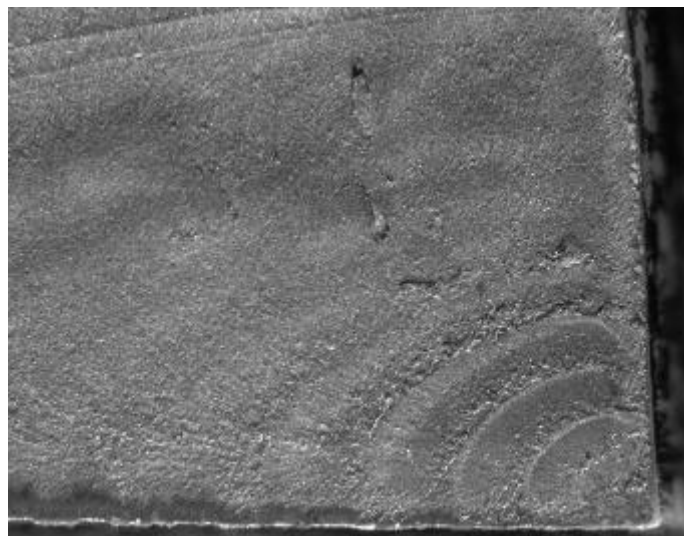
(b) 破壊起点近傍拡大
