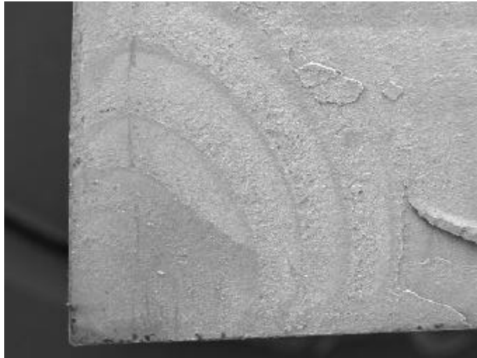
(a) 破壊起点近傍
