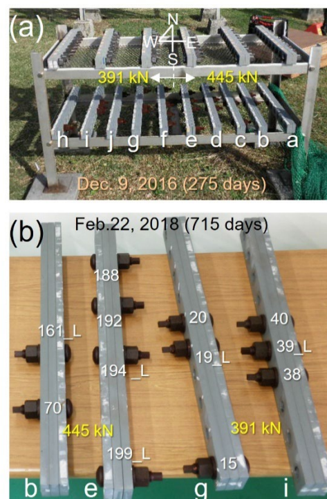
図2 2016年12月9日時点でのボルト締付体 (下段) の設置状況(a)と2018年2月22日に回収した直後の締付体の写真(b)。(b)中の「L」は触診点検で緩みが確認されたボルトを示す。
