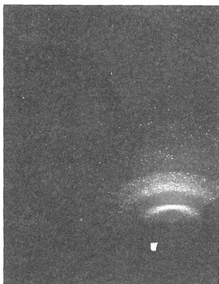
写真2 粉末X線回折計の光学系調整用のSi圧粉体の回折像
